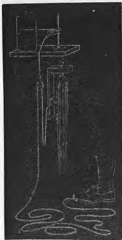
Fig. 26. — Un gros diapason dont les vibrations sont réduites par des masses de plomb à 10 par seconde agit, par un tambour explorateur relié à l'une de ses branches, sur le tambour à levier enregistreur. Celui-ci reçoit en même temps, par un tube bifurqué, l'influence des appuis et des levés des pieds du marcheur.
